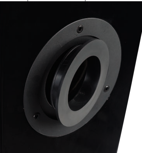
Das steckbare „Inlay“ des Reflexkanals soll eine noch etwas tiefere Grenzfrequenz im Bass ermöglichen. Sinnvoll ist dies nur in Ausnahmefällen, da auch etwas Pegel verloren geht
