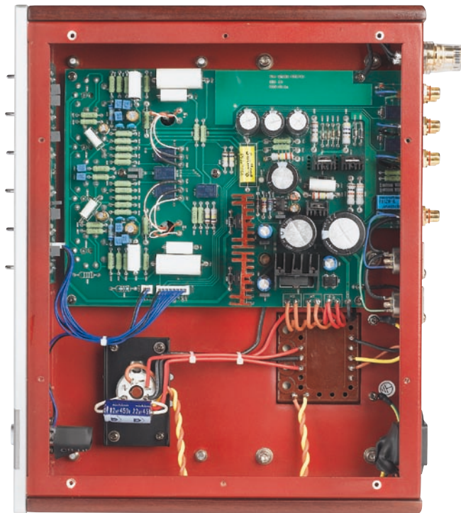
Eine große Platine dominiert das Innere der TRV-EQ3 SE – friedliche Koexistenz traditioneller und moderner Schaltungstechnik
