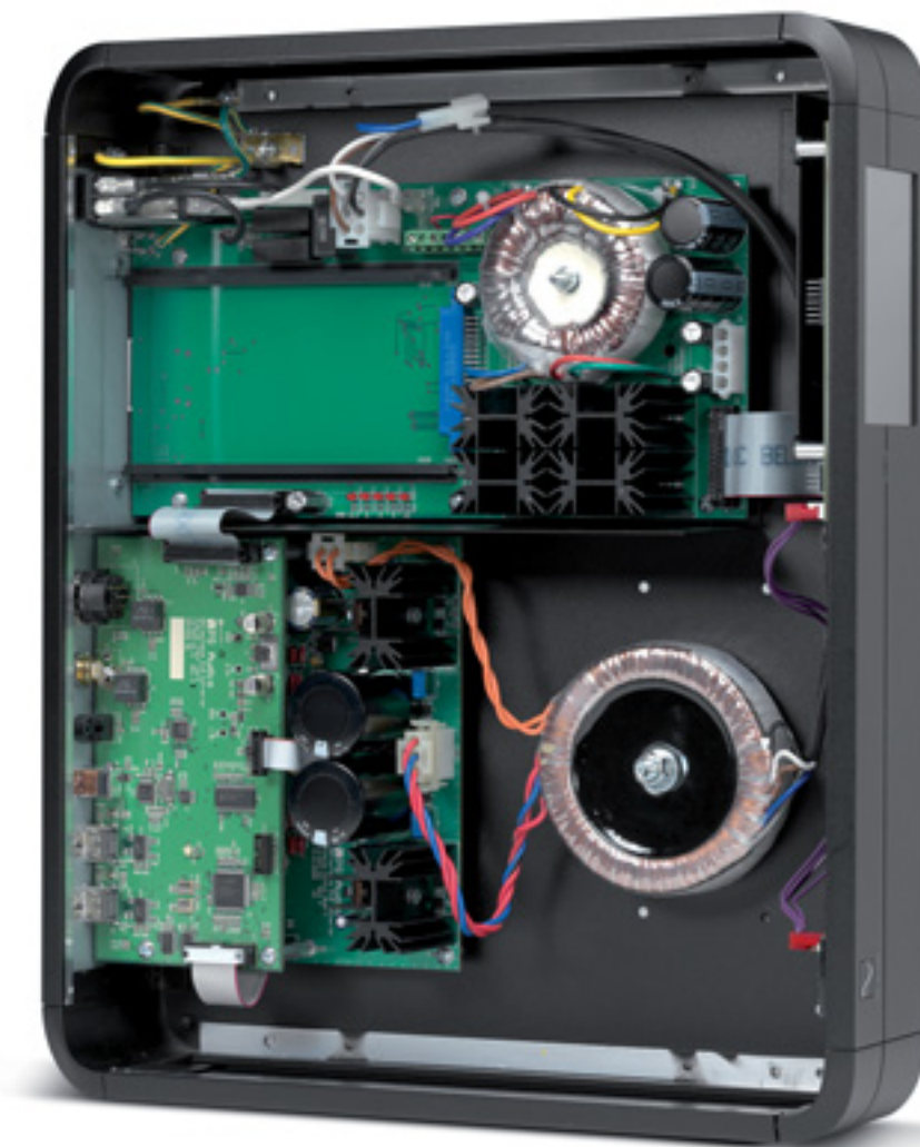
Huckepack inside: strikt getrennte Digital- und Analog-Abteile
