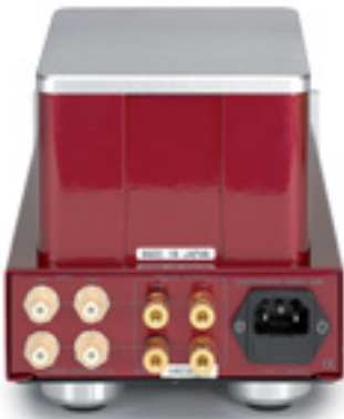
Deckeldoppel: Kleine Kunststoffkappen schützen unbenutzte Cinch-Eingänge
