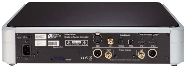
Umfangreiches Angebot an Digitaleingängen. Der Schlitz für SD-Karten dient Updates
