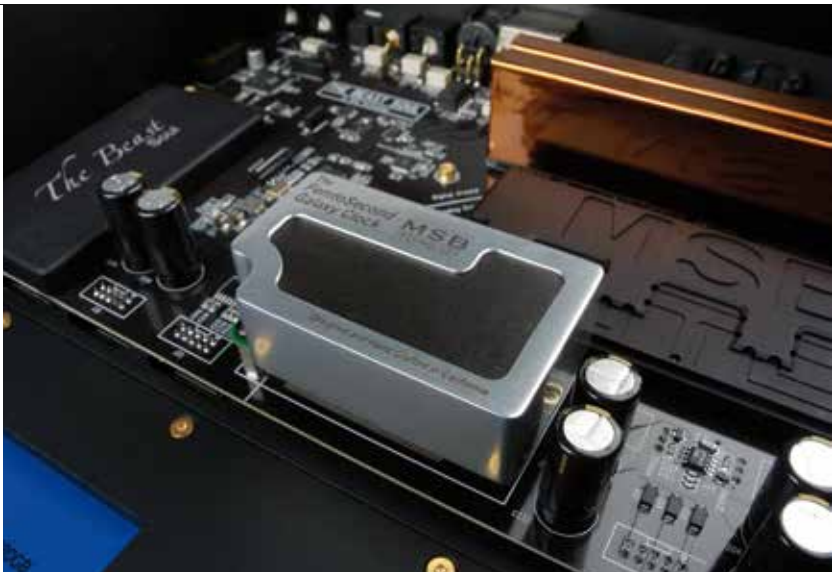
Nur das Beste: Mein Testgerät hatte die große Femto-Galaxy-Clock verbaut, die noch einmal deutlich bessere Töne erzeugt
