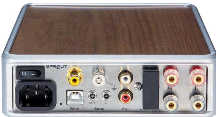
Die Analogein- und -ausgänge sind – ausgenommen Phono – als Miniklinke ausgeführt. Daneben geht es koaxial digital oder via USB-Anschluss ins Gerät und über Boxen oder Kopfhörer wieder hinaus.
