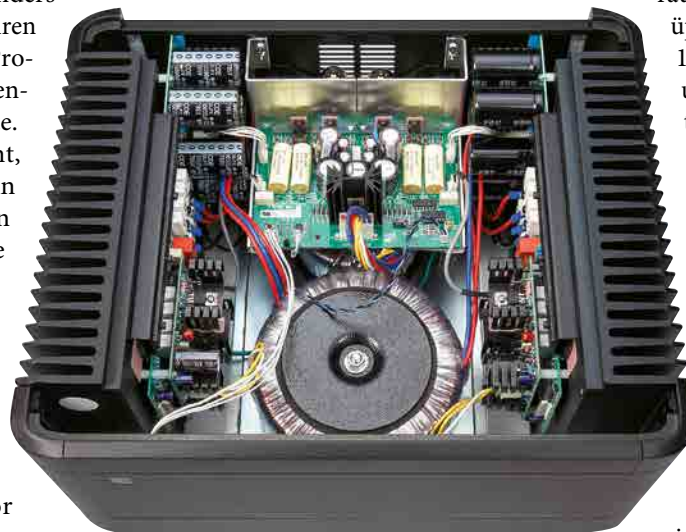
▲ Der große 1000-VA-Ringkerntrafo speist die Leistungsstufe, der kleinere versorgt die separate Röhreneingangsstufe mit Hochspannung.
