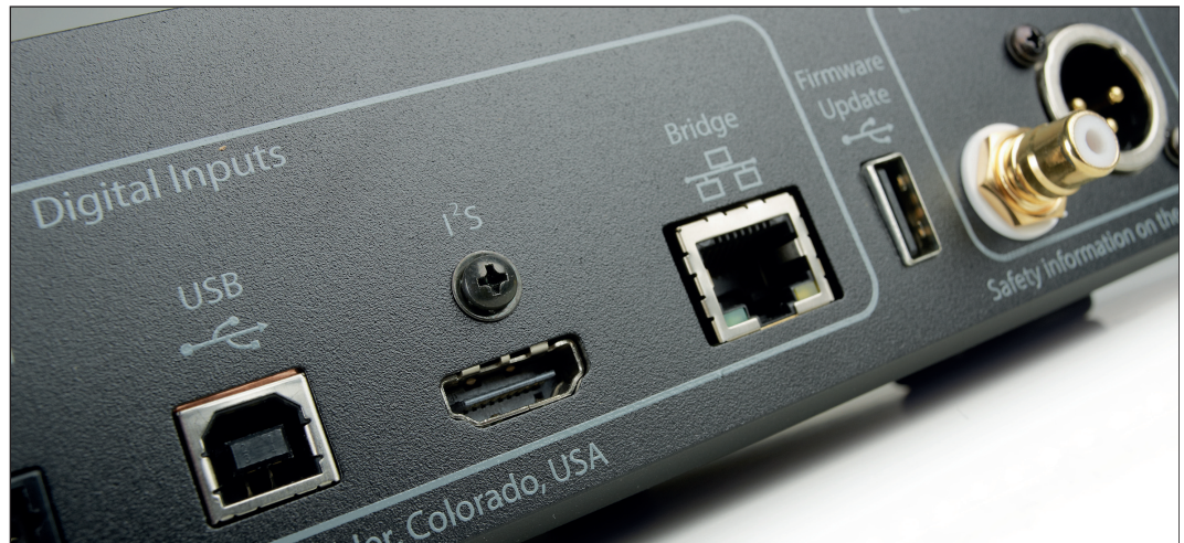
Mit USB-, I2S- und Ethernetanschlüssen ist der PS Audio perfekt aufgestellt um auch hohe Samplingraten verarbeiten zu können
