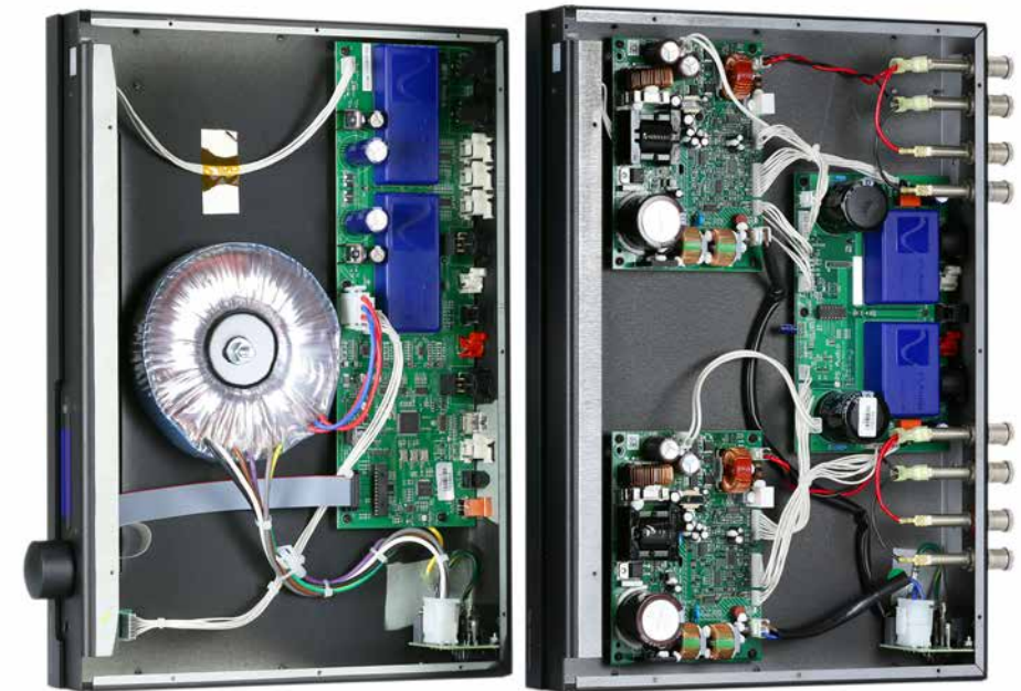
Verkehrte Welt: Der dicke Ringkerntrafo wohnt im Vorverstärker.
