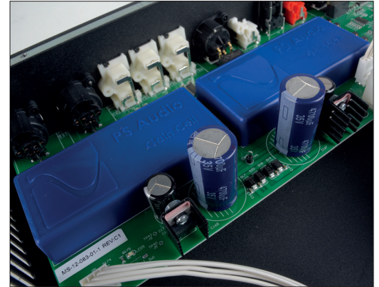
Die Gain Cells der Vorstufe setzen keinerlei zusätzliche Schaltungen in den Signalweg
