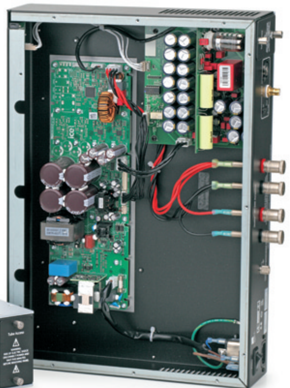
PS Audio vermählt die Eingangsrohre (oben rechts) mit einem 1.200 Watt ICE-Power-Modul der neuesten Generation.
