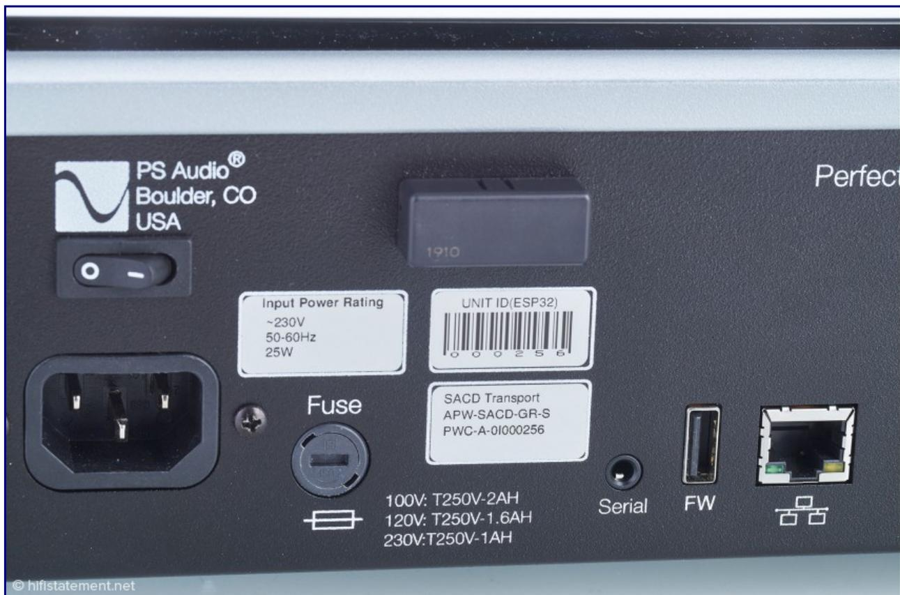
Das Kunststoff-Quader oberhalb der Etiketten beinhaltet die Wlan-Antenne. Dieser USB- und der Lan-Anschluss dienen wie Wlan der Upgrade-Option
