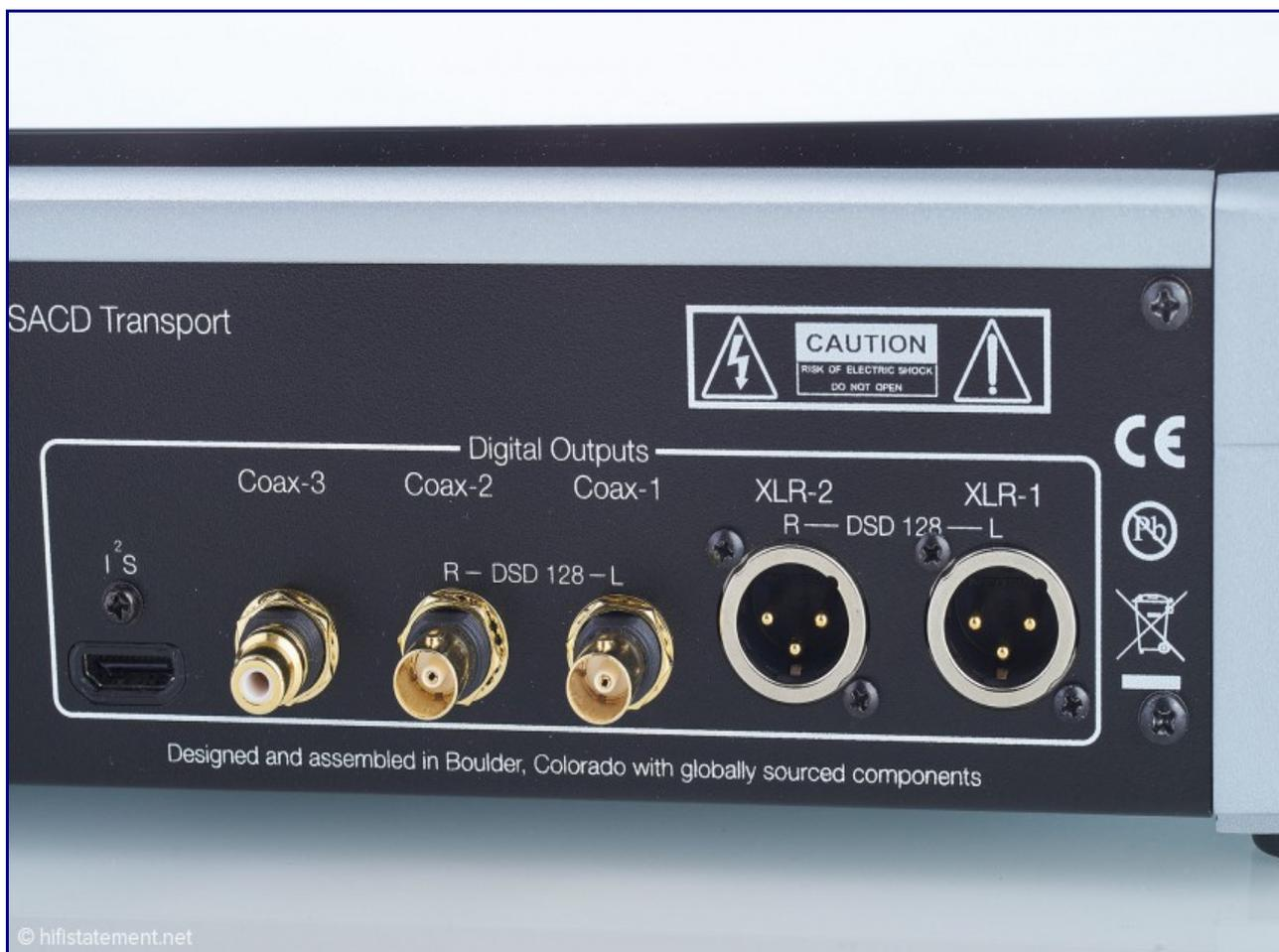
Interessant sind die kanalgetrennten AES/EBU und BNC Digital-Ausgänge zur Verdopplung der Übertragungsrate. Sie lassen sich auch ganz normal nutzen, sind dann also doppelt vorhanden
